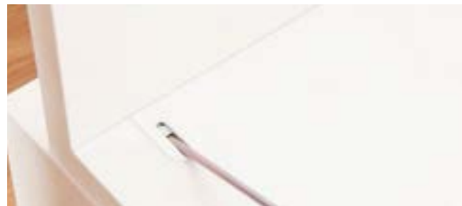
Collegare gli elementi del mobile con un cacciavite a batteria e con un bit Cabineo. Lavoro semplice e veloce con coppia preimpostata di 2,5 Nm circa.
