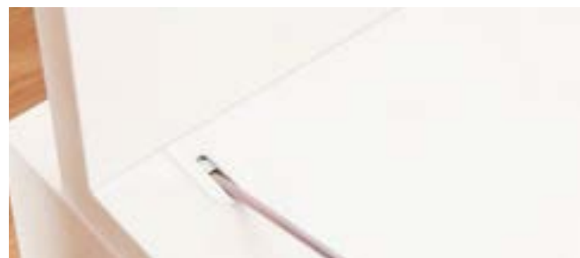
Meubelelementen met accuschroevendraaier en Cabineo- gereedschap met elkaar verbinden. Eenvoudig en snel werken met vooraf ingesteld draaimoment van ca. 2.5 Nm.
