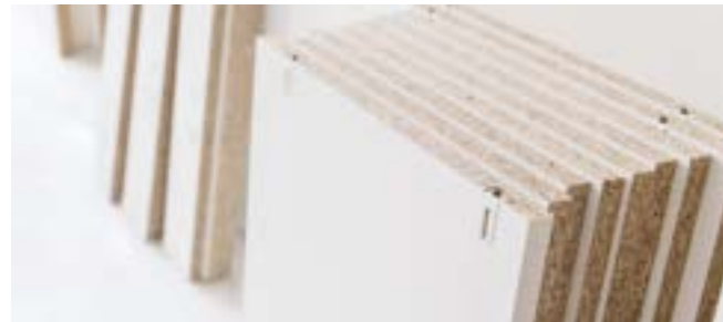
Werkstücke mit vormontiertem Verbinder als Flatpack liefern.
